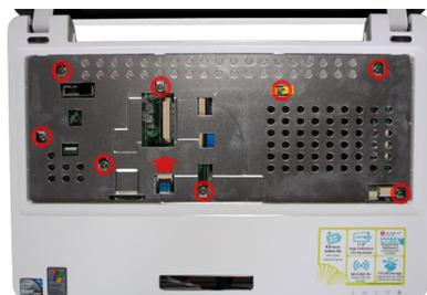
Successivamente possiamo staccare il pannello che ricopre la parte superiore della base per **raggiungere la motherboard**
