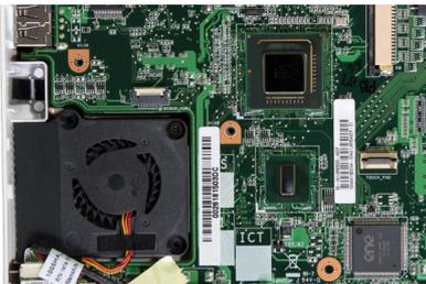
2) Modulo Bluetooth su interfaccia internal USB, batteria del BIOS e altoparlante sinistro;
